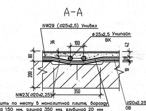
Выполнить по месту в монолитной плите борозду шириной 150 мм, длиной 350 мм, глубиной 20 мм
